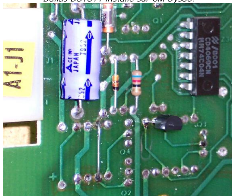
Dallas DS1811 installé sur CM Sys80.
