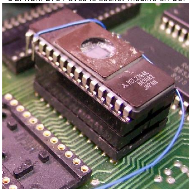
L'EPROM 2764 avec le socket modifié en U3.
